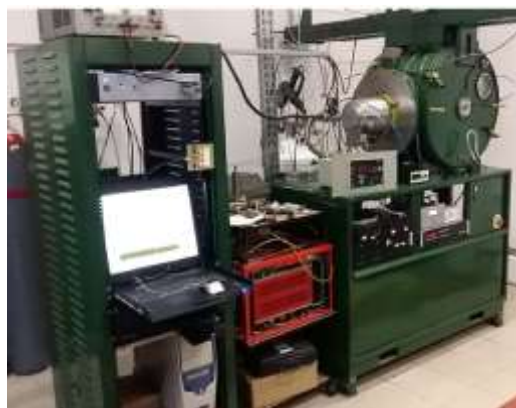
Instalatie teste vid cicluri termice
